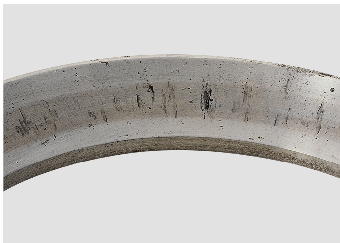
照片D-2 ·圆锥滚子轴承的外圈 ·滚道面在滚子间距出现锈蚀
