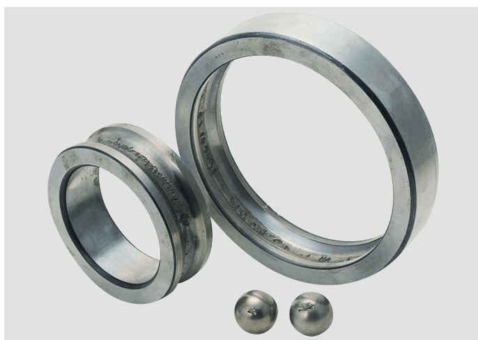
照片A-1 ·深沟球轴承 ·内圈、外圈、钢球上都发生剥落 ·原因是载荷过大
