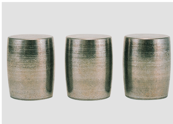
照片B-2 ·调心滚子轴承的滚子 ·滚动面产生压痕 ·原因是固体异物的啮合
