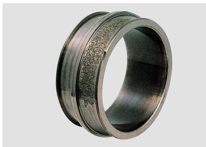
照片A-4 ·调心滚子轴承的内圈 ·仅滚道面的一列发生剥落 ·原因是轴向载荷过大
