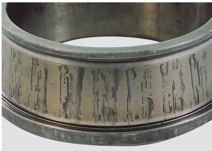
照片D-1 ·圆锥滚子轴承的内圈 ·滚道面在滚子间距出现锈蚀
