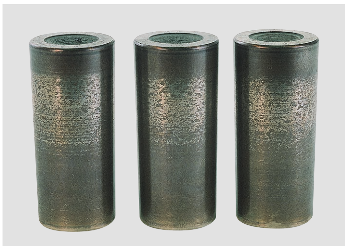
照片B-3 ·圆锥滚子轴承的滚子 ·滚动面产生压痕(两端有回火色) ·原因是润滑油中混入异物
