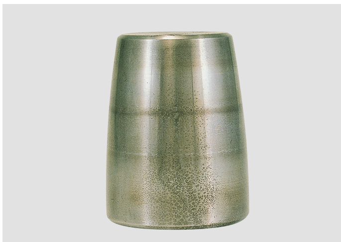
照片D-3 ·调心滚子轴承的滚子 ·滚动面出现锈蚀、腐蚀 ·原因是水的浸入
