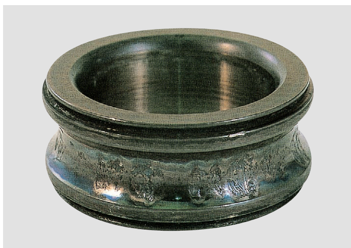
照片A-3 ·深沟球轴承的内圈 ·滚道面单侧发生剥落 ·原因是轴向载荷过大
